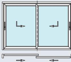
In der zweiteiligen Version wählen Sie zwischen je einem beweglichen Flügel und zwei wechselseitig verschiebbaren Elementen.
