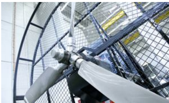
Dichtheitsprüfung Weathertightness tests
