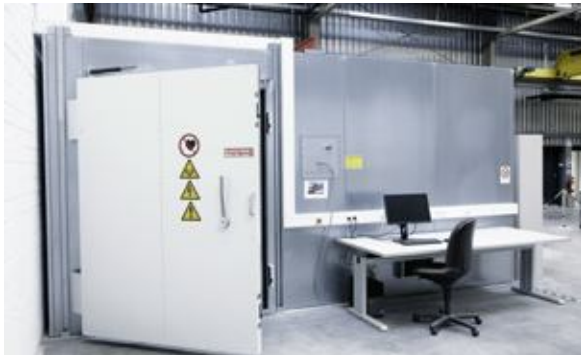
Elektronikprüfung (EMV und IP-Schutzarten) Electronics testing (EMC and IP protection ratings)
