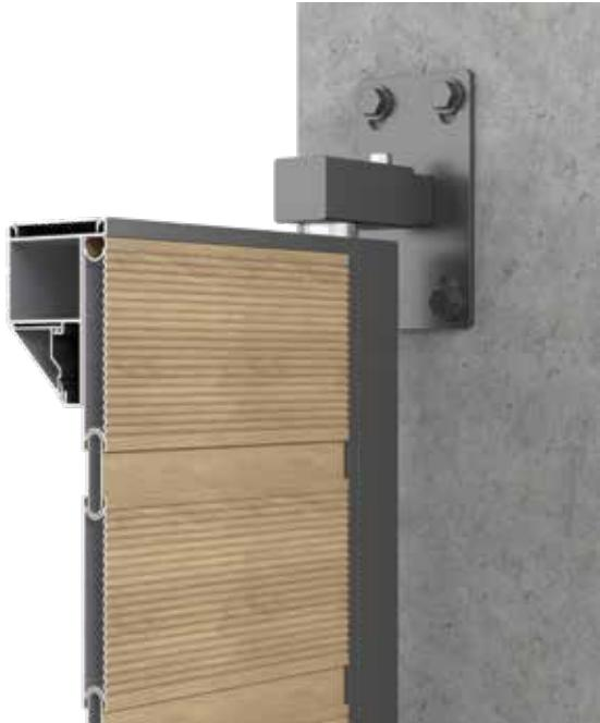
Λεπτομερείς προβολές των προφίλ του φύλλου και του αυλακωτού, μαζί με το προφίλ του άξονα περιστροφής και το PIN INOX 316 ικανό να αντέξει 250 κιλά το καθένα. Η μέγιστη διάσταση φύλλου είναι κοντά στα 4m<sup>2</sup>, με μέγιστο φορτίο ανέμου 2KPa.
